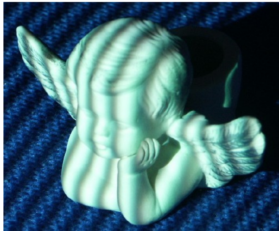
Projection d'une sinusoïde en niveaux de gris
