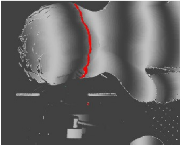
Paramétrisation 1D induite par la première orientation de franges
