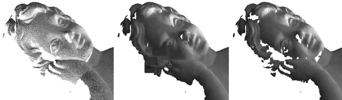
FIG. 3.7 – Gauche : le nuage de points initial, avec la couleur. L'observateur est suffisamment proche pour que les discontinuités apparaissent. Centre : reconstitution de la surface par splats. Le rayon des sphères englobantes est calculé directement à partir de l'adjacence implicite de la carte géométrique, sans tenir compte des occlusions. Sur les bords de l'objet, les splats sont trop grossières. Droite : le calcul du rayon a été corrigé. On observe de ce fait plus de trous, mais ceux-ci correspondent à des zones non-visibles par le dispositif d'acquisition et sont donc cohérents.
