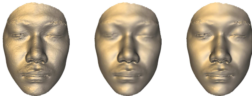
FIG. 1 – Gauche : maillage bruité issu de la numérisation 3D d'un visage. Milieu : débruitage par simple filtre moyenneur. De nombreuses caractéristiques géométriques sont altérées. Droite : débruitage adaptatif. Les fins détails de la surface sont préservés du mieux possible.
